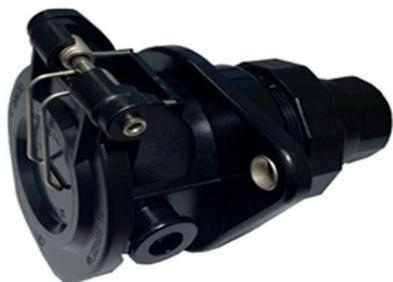
Соединители типа ШЦ1, с фиксацией сочлененного положения специальным металлическим зажимом, защищенного исполнения на номинальное напряжение до 24 В, применяются в спиральных кабелях ABS и подключении светотехники для буксирующего и буксируемого транспортных средств.
