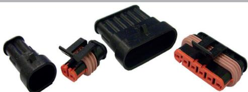
Электрические соединители (розетки и вилки), прямоугольные (с линейным расположением контактов), герметичные, типа СПГ, с фиксацией сочленённого положения защёлкой, предназначены для использования в изделиях автотракторного электрооборудования для монтажа жгута проводов с медными жилами сечением от 0,3 до 2,5 мм<sup>2</sup>. Климатическое исполнение «О» по ГОСТ 15150-69. Выпускаются по Ф5.3723.018 ТУ.
