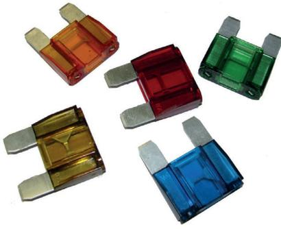
Предохранители плавкие ножевого типа серии «Махи» предназначены для защиты электрических цепей автомобиля, с номинальным напряжением до 32 В, при перегрузках и коротких замыканиях
