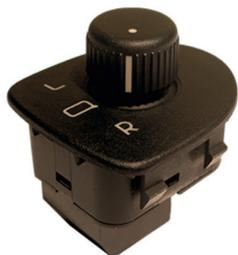
Переключатель предназначен для дистанционного управления наружными зеркалами заднего вида автомобиля.
