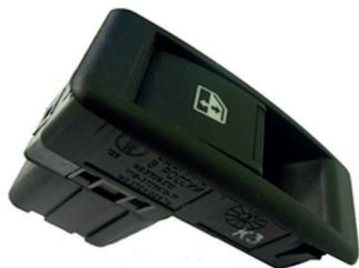
Переключатель стеклоподъёмника предназначен для коммутации электрических цепей электродвигателей приводов стеклоподъёмников пассажирских дверей. Климатическое исполнение «У,Т» по ГОСТ 15150-69. Выпускаются по Ф5.3709.009 ТУ.
