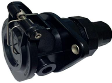
Соединители типа СНЦ1, с фиксацией сочлененного положения специальным металлическим зажимом, защищенного исполнения на номинальное напряжение до 24 В, применяются в спиральных кабелях ABS и подключении светотехники для буксирующего и буксируемого транспортных средств. Климатическое исполнение «О».
