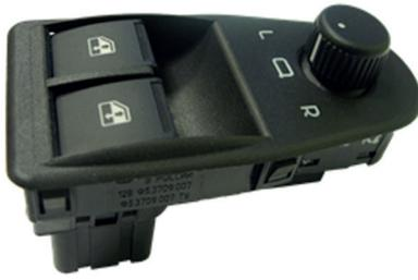
Блоки переключателей стеклоподъёмников предназначены для коммутации электрических цепей электродвигателей приводов стеклоподъёмников и электроприводами зеркал заднего вида автомобилей. Блоки размещаются на водительской двери автомобиля.
