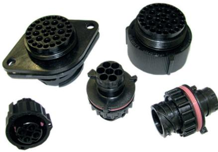
Соединители электрические цилиндрические разъёмные, с фиксацией сочленённого положения накидной гайкой байонетного типа, защищённого исполнения, типа СЦБ, предназначены для использования в изделиях автотракторного электрооборудования для монтажа жгута проводов с медными жилами сечением от 0,5 мм<sup>2</sup> до 5,3 мм<sup>2</sup>. Климатическое исполнение «О».
