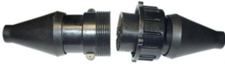
Соединители электрические цилиндрические разъёмные, с фиксацией сочленённого положения накидной гайкой, защищённого исполнения типа СЦ7, предназначены для использования в изделиях автотракторного оборудования для монтажа жгута проводов с медными жилами сечением от 0,5 до 6 мм<sup>2</sup>.
