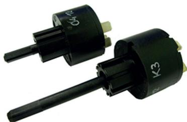
Переключатели отопителя предназначены для коммутации электрических цепей вентилятора отопителя салона автомобилей.
