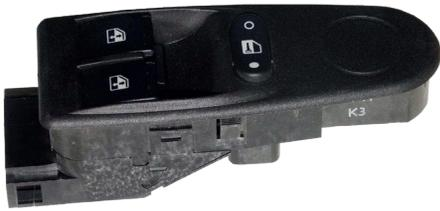
Блок переключателей стеклоподъемников и блокировки дверей предназначен для коммутации электрических цепей электродвигателей приводов стеклоподъемников и для блокировки дверей с места водителя. Климатическое исполнение «У, Т» по ГОСТ 15150-69. Изготавливаются в соответствии с техническими условиями Ф5.3709.009 ТУ.
