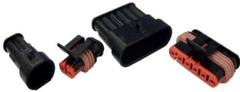
Электрические соединители (розетки и вилки), прямоугольные (с линейным расположением контактов), герметичные, типа СПГ, с фиксацией сочленённого положения защёлкой, предназначены для использования в изделиях автотракторного электрооборудования для монтажа жгута проводов с медными жилами сечением от 0,3 до 2,5 мм<sup>2</sup>.
