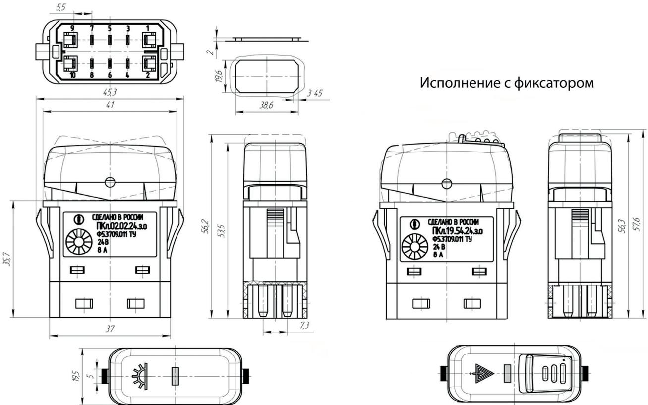
Исполнение с фиксатором
