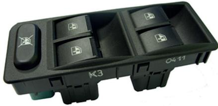
Блок переключателей стеклоподъемников с выключателем блокировки стеклоподъемников, предназначен для коммутации электрических цепей электродвигателей приводов стеклоподъемников двери водителя и пассажирских дверей с места водителя, а так же для блокировки стеклоподъемников пассажирских дверей с места водителя. Климатическое исполнение «У,Т» по ГОСТ 15150-69. Выпускаются по Ф54.3709.005 ТУ.
