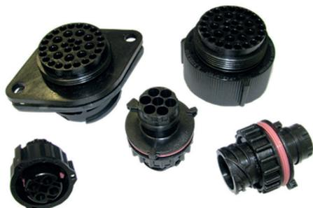
Соединители электрические цилиндрические разъёмные, с фиксацией сочленённого положения накидной гайкой байонетного типа, защищённого исполнения, типа СЦБ, предназначены для использования в изделиях автотракторного электрооборудования для монтажа жгута проводов с медными жилами сечением от 0,5 мм<sup>2</sup> до 5,3 мм<sup>2</sup>.
