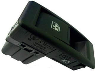
Переключатель стеклоподъёмника предназначен для коммутации электрических цепей электродвигателей приводов стеклоподъёмников пассажирских дверей. Климатическое исполнение «У,Т» по ГОСТ 15150-69. Выпускаются по Ф5.3709.009 ТУ.
