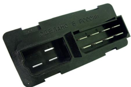
Соединители электрические (вилки) для печатного монтажа, предназначены для использования в изделиях автотракторного электрооборудования. Климатическое исполнение «О» по ГОСТ 52230. Выпускаются по Ф5.3723.004 ТУ. Основные параметры: Диапазон рабочих температур от -60 °С до +80 °С. Номинальное напряжение до 24В.
