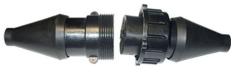
Соединители электрические цилиндрические разъёмные, с фиксацией сочленённого положения накладной гайкой, защищённого исполнения типа СЦ7, предназначены для использования в изделиях автотракторного оборудования для монтажа жгута проводов с медными жилами сечением от 0,5 до 6 мм<sup>2</sup>.
