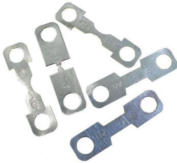
Вставки плавкие предназначены для защиты электрических цепей автомобилей при перегрузках и коротких замыканиях. Устанавливаются в блоки БПР-2, БПР-2М, БПР-4, БПР-5-4.
