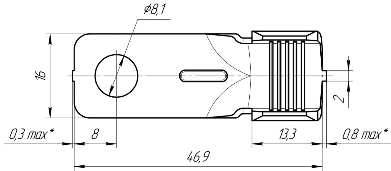
1. \*Остаток от технологической перемычки после обрубки
