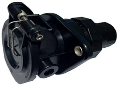
Соединители типа ШЦ1, с фиксацией сочлененного положения специальным металлическим зажимом, защищенного исполнения на номинальное напряжение до 24 В, применяются в спиральных кабелях ABS и подключении светотехники для буксирующего и буксируемого транспортных средств. Климатическое исполнение «О». Выпускаются по Ф5.3723.033 ТУ.
